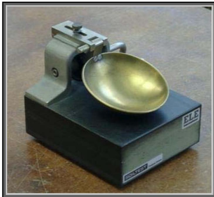
**Figure 3** : Appareil de Casagrande (cliché de l'auteur)
