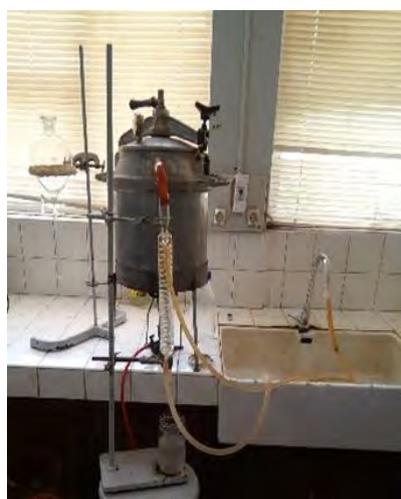
**Photo 7:** Dispositif d'extraction des huiles essentielles par entraînement à la vapeur
