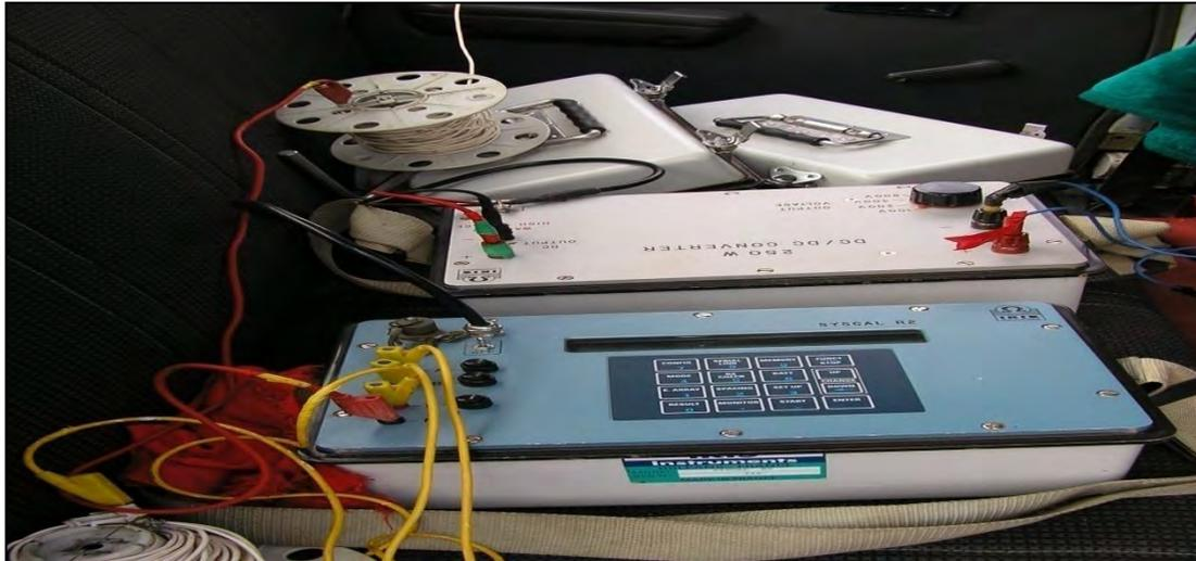
**Figure 13:** Résistivimètre à courant alternatif type SYSCAL R2 et convertisseur et dispositif de sondage électrique
