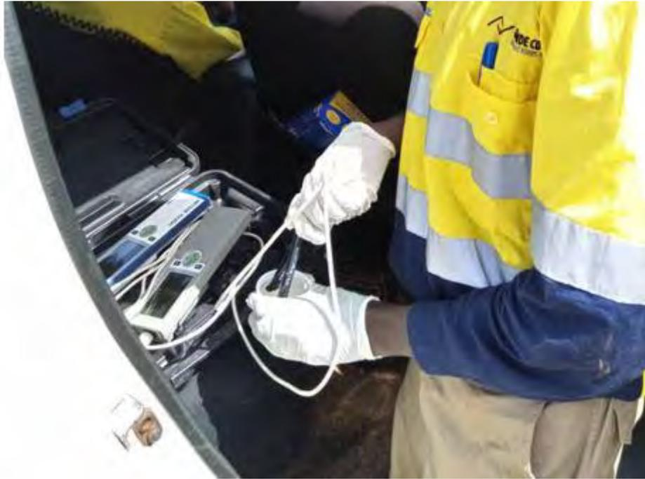
**Photo 2 : Mesure des paramètres *in situ* des eaux avec l'appareil multiparamètre Orion Star A239.**
