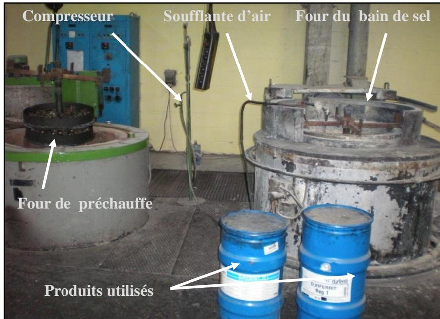
Figure II.1 : Installation de nitrocarburation en bain de sel (Procédé TENIFER).
