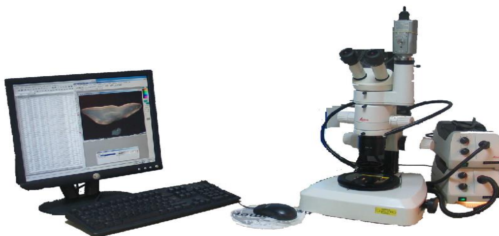
Figure 16. Dispositif d'observation utilisé pour l'analyse numérique de l'âge à partir du logiciel TNPC (Traitement Numérique des Pièces Calcifiées).
