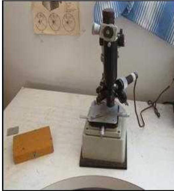
Figure III.4: Microduromètre ZWICK. [Laboratoire de métallurgie, Annaba]
