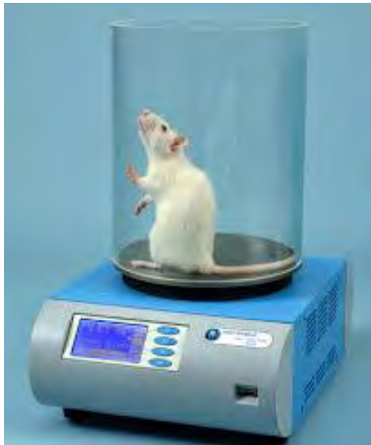
Figure 31 : Modèle de plaque chauffante
