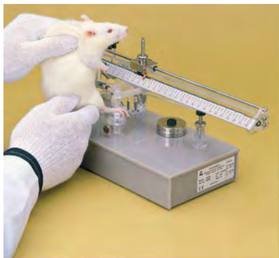
Figure 32 : Algimètre : Modèle de Randall-Selitto
