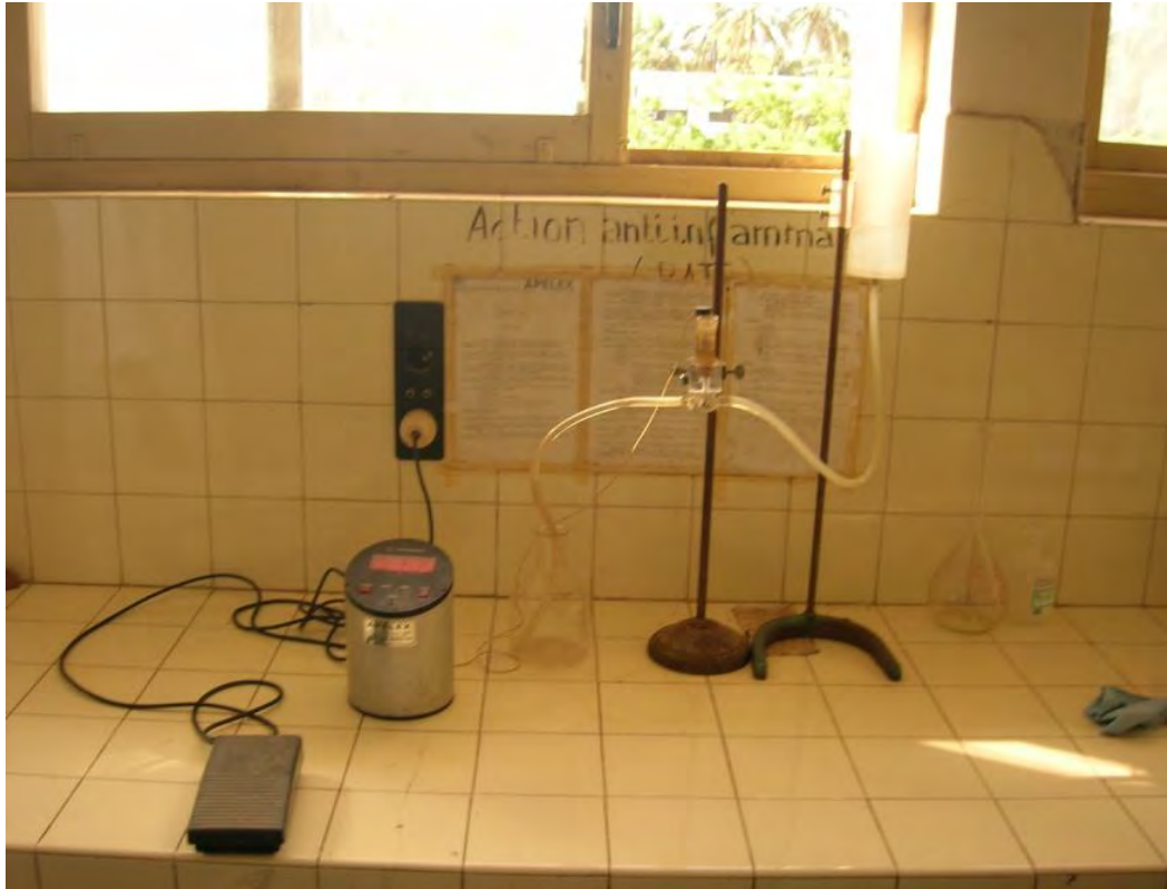
Figure 34 : Pléthysmomètre à eau (APELEX 05-7150)
