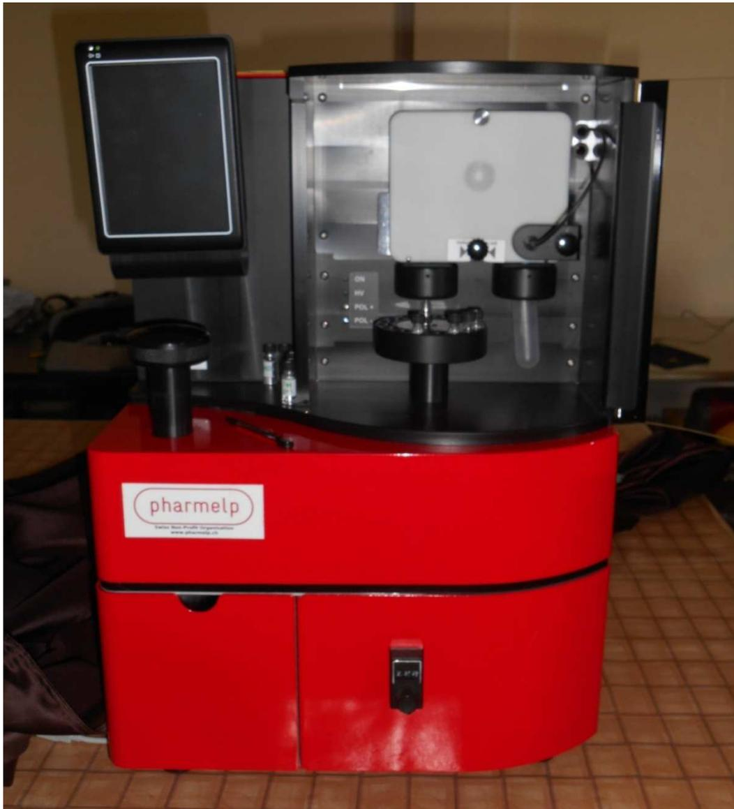
**Figure 6 : Appareil d'électrophorèse capillaire**
