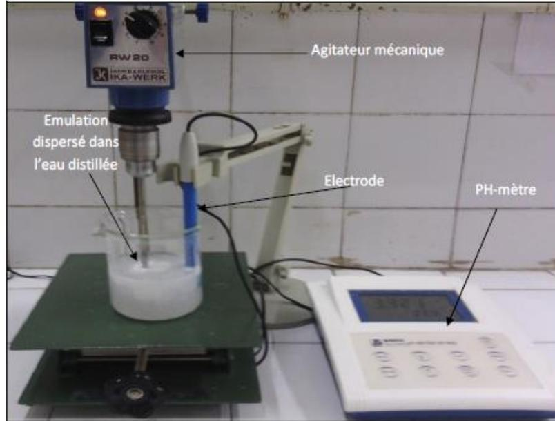
Figure II.2 : Montage expérimental pour l'étude de la stabilité des émulsions (E/H/E).
