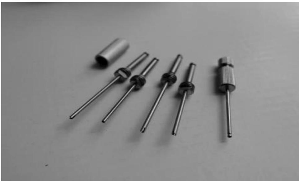
**Figure 4:** Les instruments du kit de Masserann (42).
