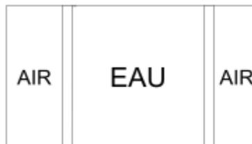
A l'intérieur du tube, il existe une convection entre l'eau et la paroi intérieure. Et à travers le tube se présente une conduction. A l'extérieur on rencontre aussi une convection entre la paroi extérieure et l'air.
