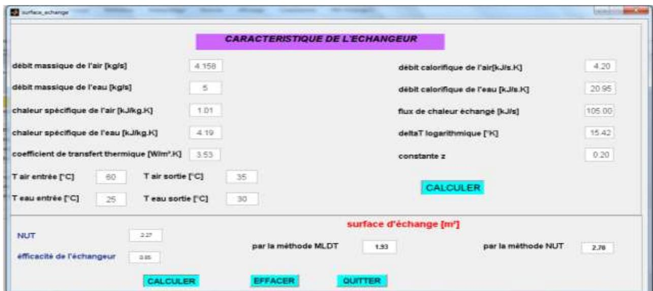
Figure 30: Interface calculant la surface d'échange
