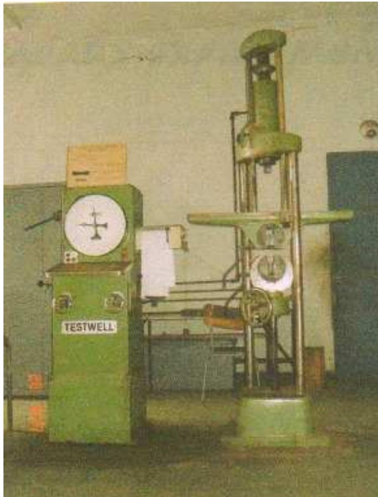
Figure n°12 : Appareil de mesure des résistances à la compression (TESTWELL)
