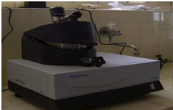
**Figure 26** : Broyeur a mortier RM 100
