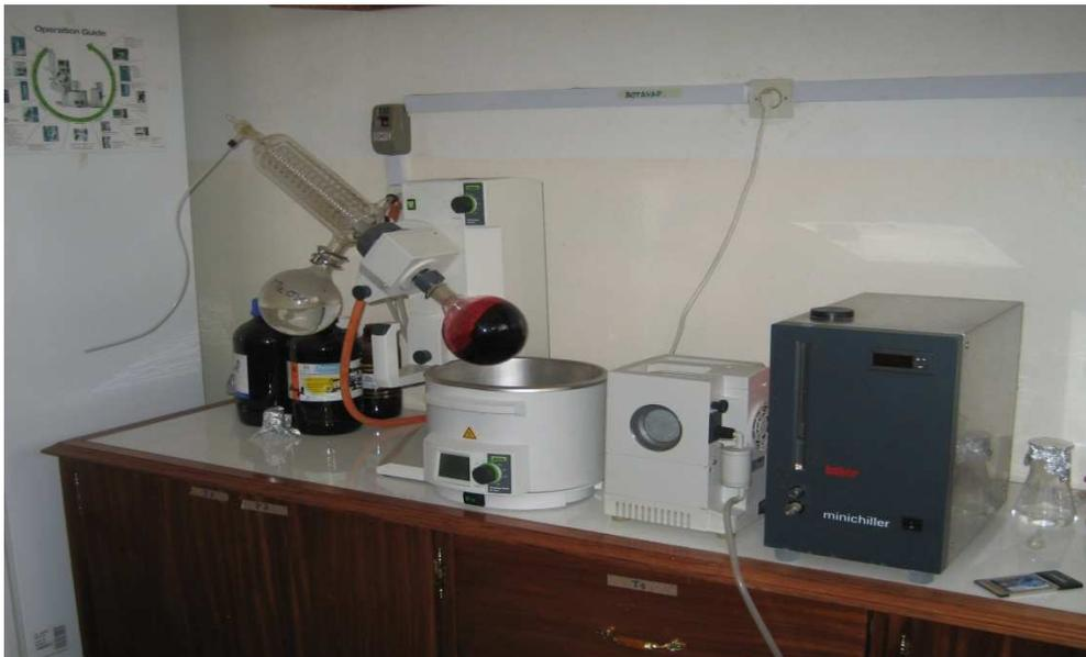
**Figure 27** : Evaporateur rotatif
