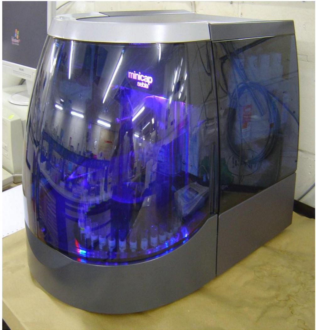
**Figure 18** : appareil électrophorétique Minicap
