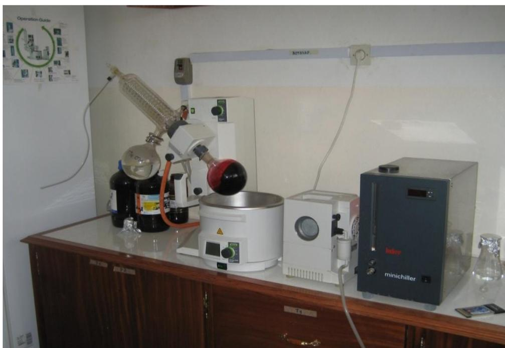
**Figure 24** : Evaporateur rotatif
