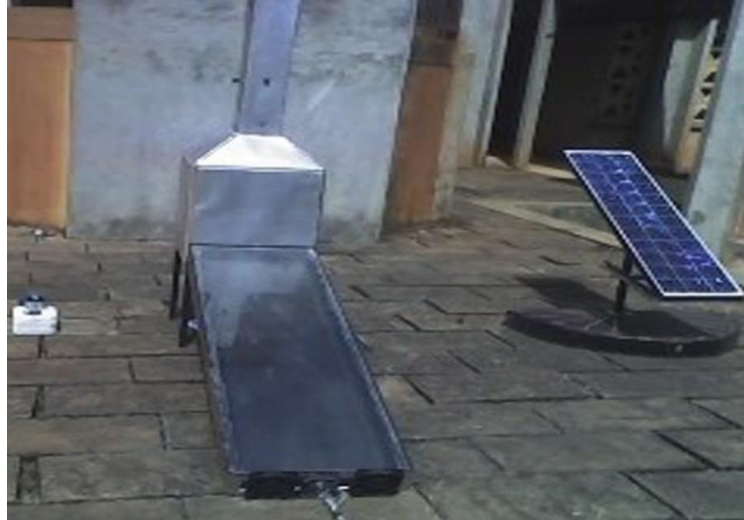
Figure 14: Séchoir solaire indirect avec cellule photovoltaïque pour la régulation de la température [56].
