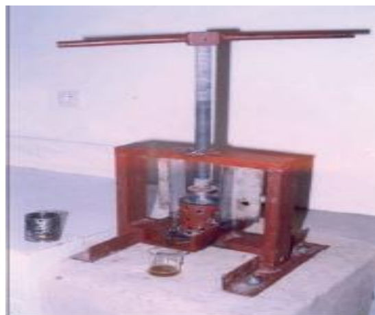
Figure 16: Presse manuelle à vis verticale pour l'extraction du beurre de karité [56].
