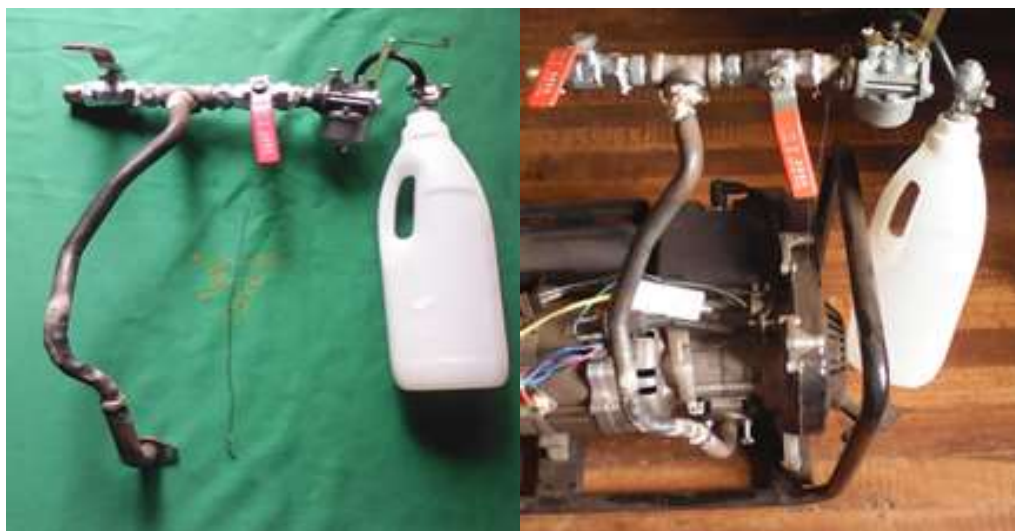
Photo 7: Montage permettant le chauffage du réacteur
