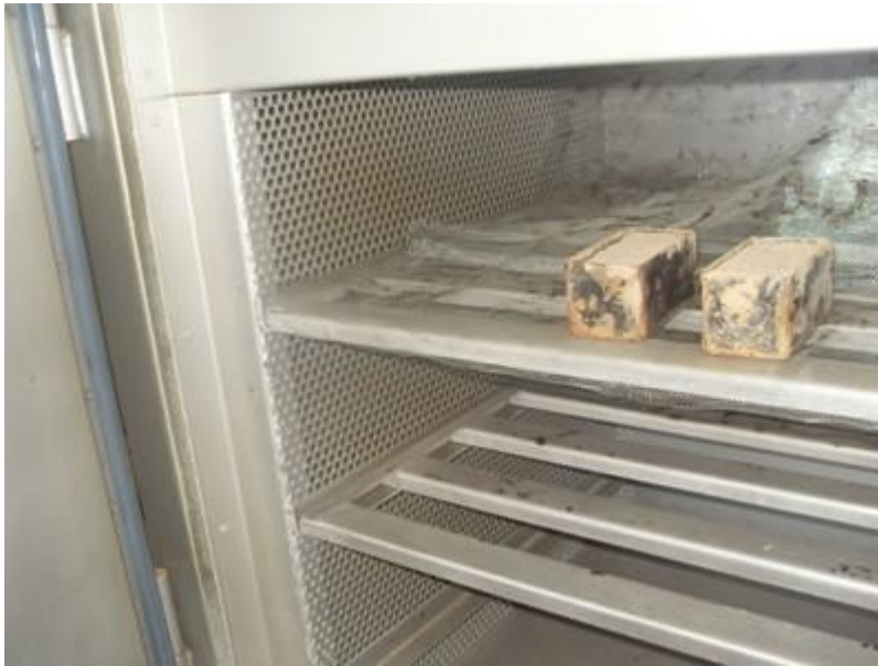
Figure 1. Chauffage d'un moule de brique
