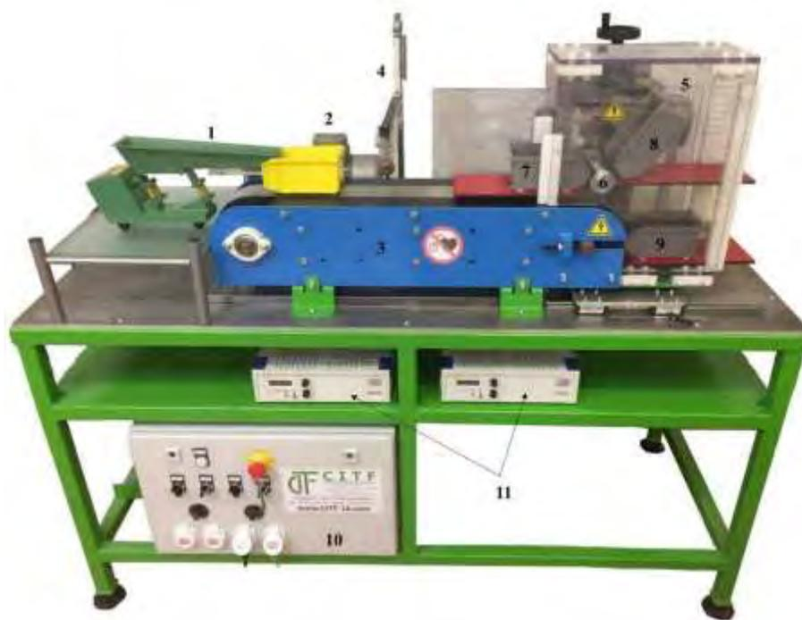
**Figure 14 : Le séparateur électrostatique multifonctions à électrode-convoyeur**
