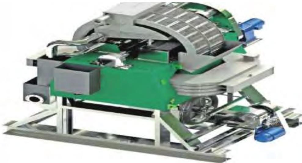
Figure 16 : Le séparateur magnétique à haut gradient
