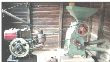
Figure 24 : Moteur diesel fonctionnant avec l'huile de *Jatropha* (Cliché : ÜLLENBERG A., 2009).
