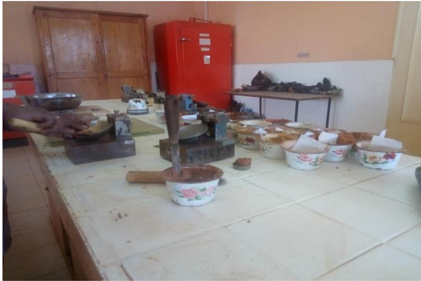
**Photo 6 : Appareillages d'Atterberg [W8]**
