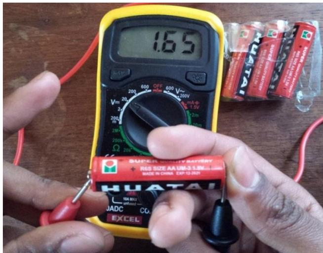
Figure 28 : Mesure de la force électromotrice d'une pile neuve de dimension AA.
