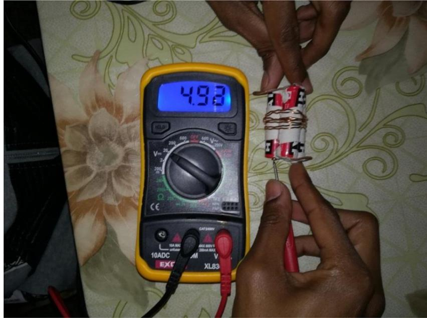
**Figure 30 : Mesure de la force électromotrice des trois piles neuves combinées de dimension AA.**
