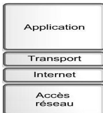
**Figure 1.02 :** *Modèle TCP/IP*
