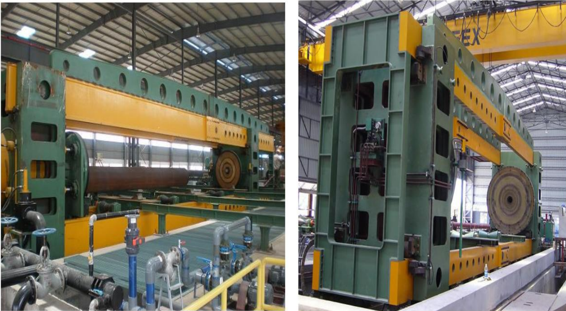
Figure IV. 3 Banc d'épreuve de l'essai hydrostatique.
