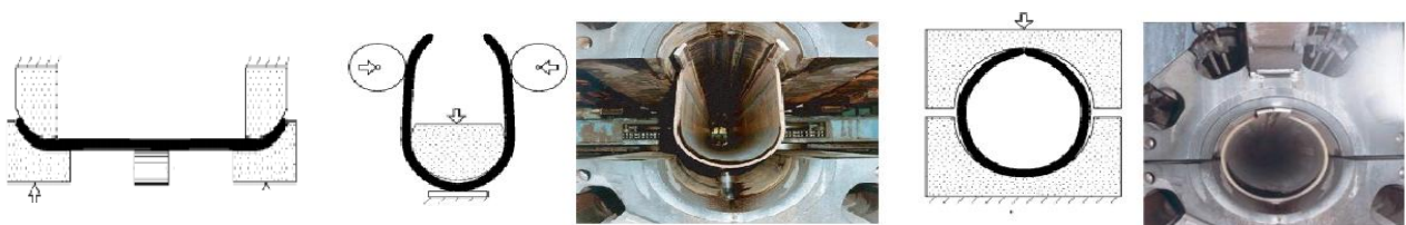
Figure I. 3 a) : Croquage b): Formage sous forme "U" c): Formage sous forme "O".
