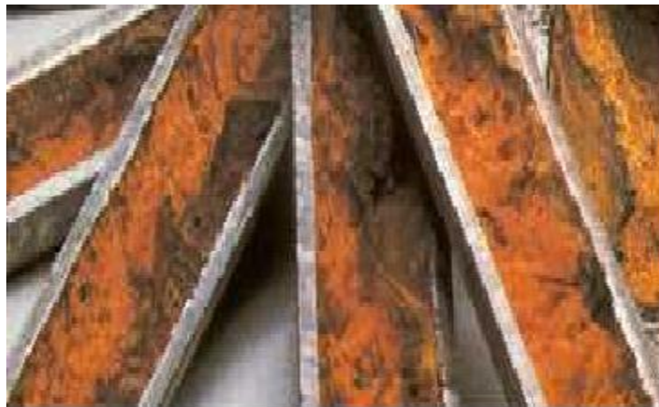
Figure III. 9 Corrosion interne (corrosion généralisée).
