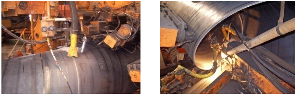
Figure I. 4 Soudage d'un tube.
