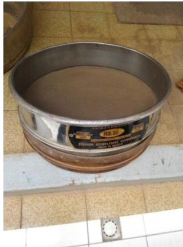
Photo 12 : Exemple de Tamis à 35 mesh
