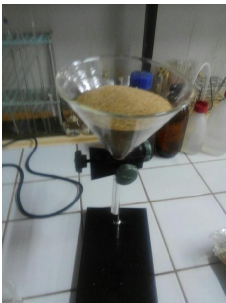
Photo 16 : Système de détermination de la porosité efficace
