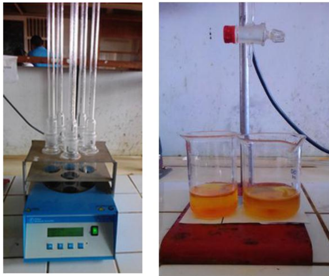
Photo 8 : Appareillage et mesure du DCO
