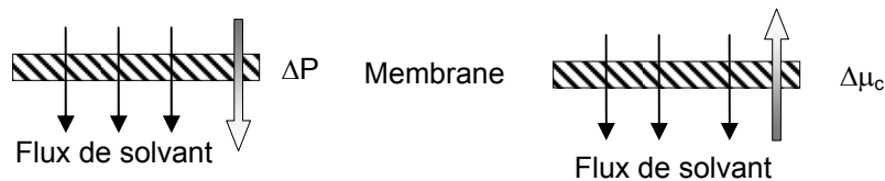
Figure II-1 : schéma de principe général de la filtration par membrane avec un gradient de pression.
