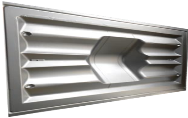
Figure 2 : Exemple de tôle issue d'un formage SPF conventionnel [3]
