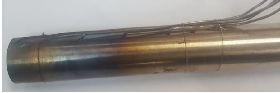
Figure 145 : Barreau en inox 310 instrumenté
