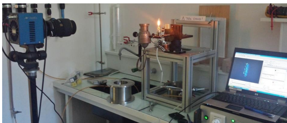
Figure 19 : Mesure du gradient thermique sur le filament de la lampe USHIO® JVC 1000 W
