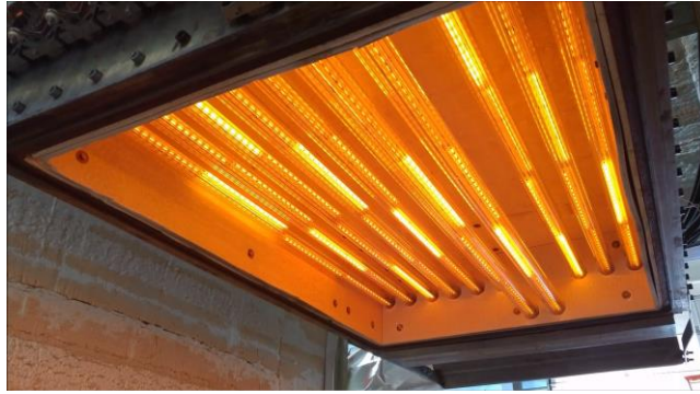
Figure 4 : Exemple de plateau de chauffage pour un formage SPF-IR[3]
