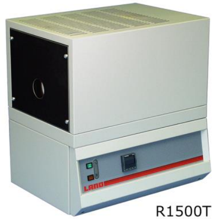
Figure 36 : Corps noir de laboratoire Land® R1500T utilisé dans ces travaux
