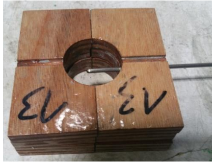
Figure 226 : Élément du moule en bois stratifié
