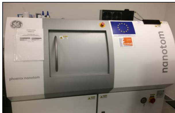
Figure 19. Micro-CT Phoenix/GE Nanotom 180 (CIRIMAT Toulouse UMR 5085).
