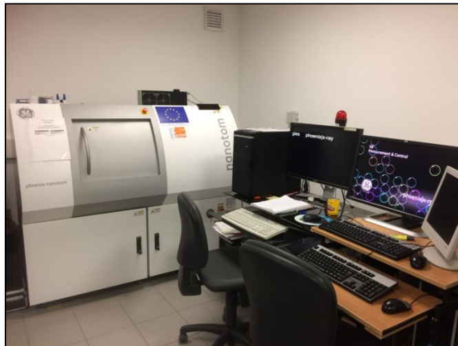
Figure 45. Micro-CT Phoenix/GE Nanotom 180 (CIRIMAT Toulouse UMR 5085).
