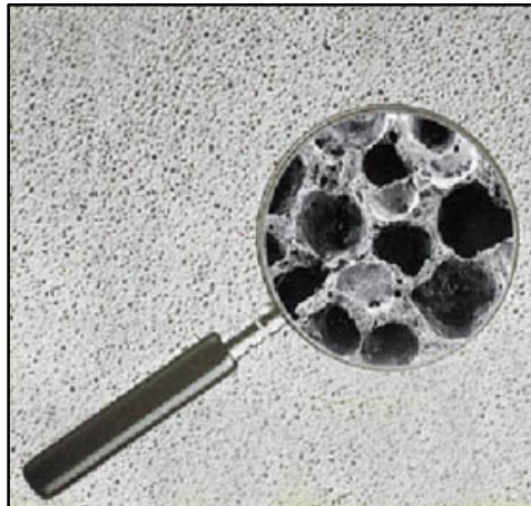
Figure 2 : Présentation schématique d'un béton cellulaire
