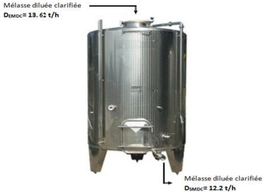
Figure.18. La cuve de la mélasse diluée clarifiée
