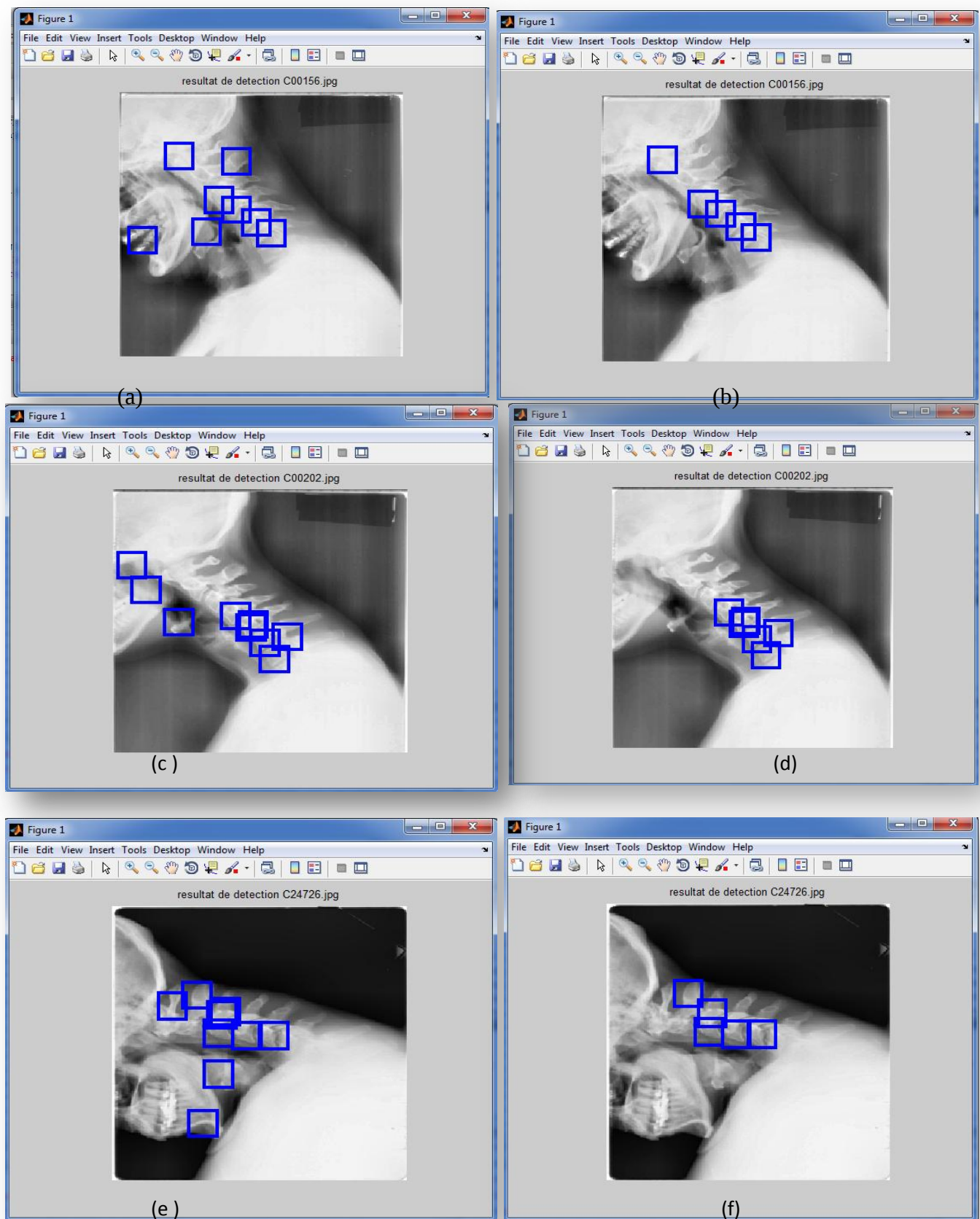
Figure17 : Quelques résultats de détection sur des images test.(a)-(c)-(e) avant raffinement,(b)-(d)-(f) résultat de détection après raffinement par corrélation.
