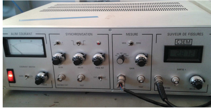
FIGURE 2.27 – Suiveur de fissure.
