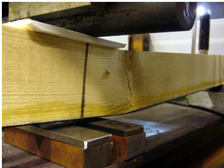
Figure 2.14. Poutre renforcée. Rupture en traction.
