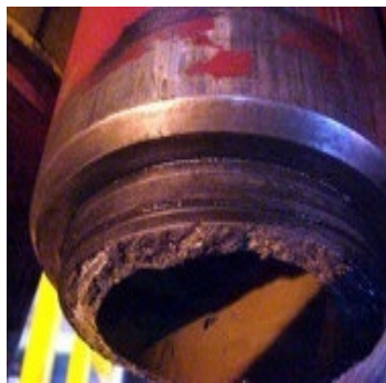
Figure 1.9: Rupture d'une Tige de Forage
