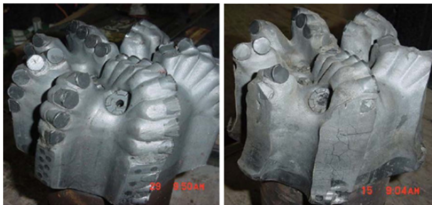
Figure 1.10: Gauche: Outil Neuf, Droite: Outil Ayant Subi des Vibrations Sévères (Mensa-Wilmot et al., 2010)
