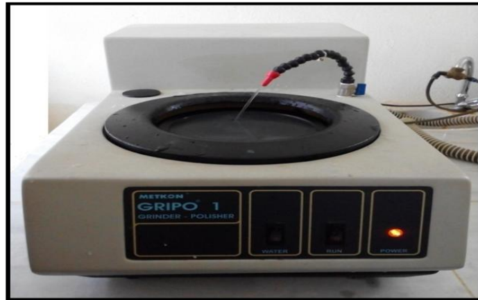
Figure II.1. Machine de polissage mécanique utilisée pour la préparation d'échantillons
