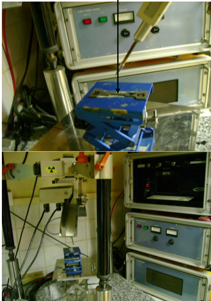
Figure II. 8. Appareillage SET-X utilisé pour les mesures des contraintes internes et l'élargissement des pics
