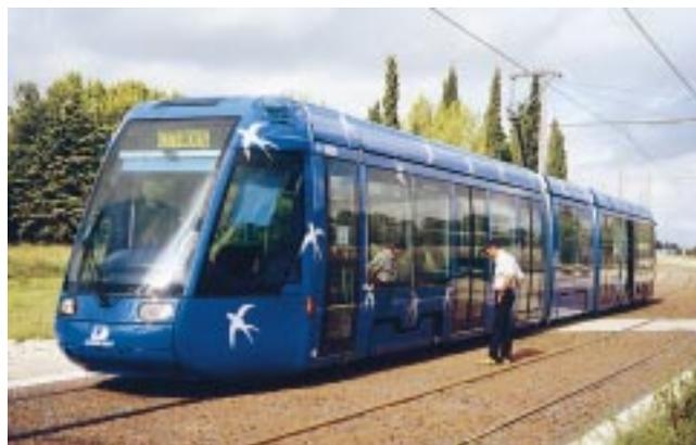
Figure 17 – Tramway Citadis de Montpellier, premier tramway français au gabarit de 2,65 m
