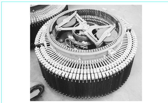
Figure 12 – Accélérateur rotatif Westinghouse de la plupart des motrices PCC
