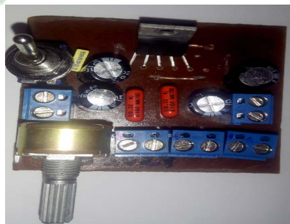
Figure III.20 : Réalisation pratique de notre mini-amplificateur audio de puissance utilisant le circuit intégré YD1028.
