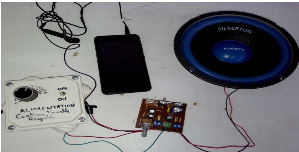
Figure III.8 : Réalisation et test pratique de notre mini-amplificateur audio de puissance utilisant le circuit intégré TDA2030.
