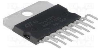
Figure III.13 : Boîtier du TDA7377.
