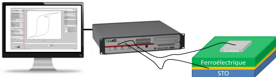
Figure 2.21 : l'équipement de mesure de la polarisation composé d'un TF analyser 1000 de AIXACT et deux pointes.
