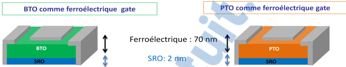
Figure 5.20 : Schéma représentatif du dispositif à effet de champ ferroélectrique composé de Pt/BTO/SRO/STO (à gauche) et Pt/PTO/SRO/STO (à droite).
