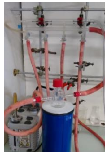
Figure 29: équipement de la rampe à vide.
