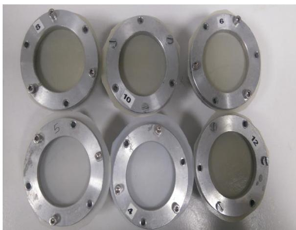
**Figure. IV.7.** Coupelles utilisées pour les études de la perméabilité à la vapeur d'eau.
