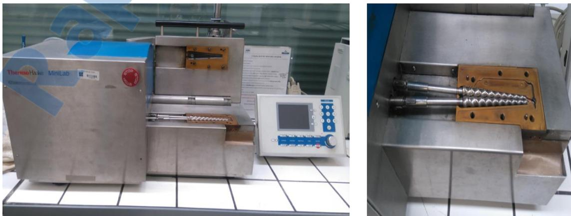
**Figure. IV.1.** Extrudeuse bavis utilisée pour la préparation des nanocomposites.
