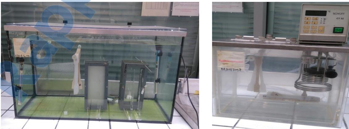
**Figure. IV.8.** Cuve de vieillissement, milieu: eau distillée à 25°C (à gauche) et 40°C (à droite).
