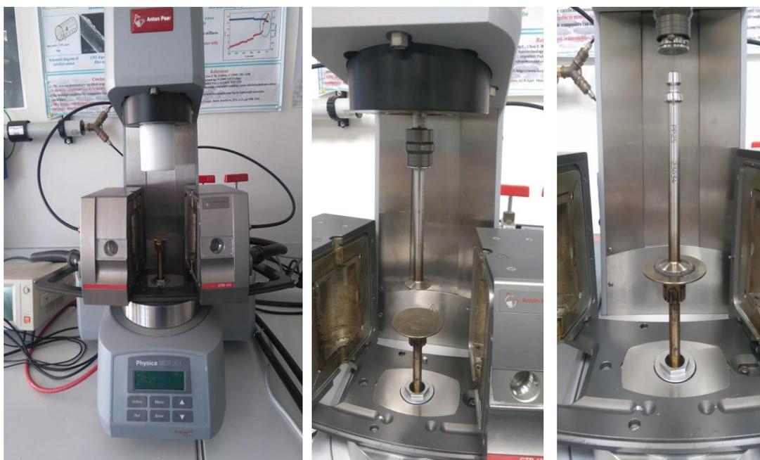
**Figure. IV.4.** Rhéomètre utilisé pour les mesures rhéologiques.
