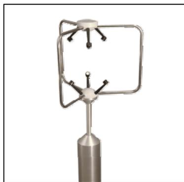
Figure 5.7 Anémomètre ultrasonique 3D
