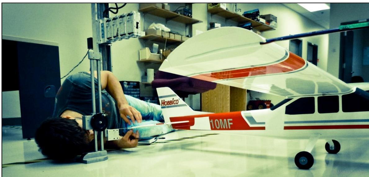
Figure 3.2 Mesure du débattement des surfaces de contrôle
