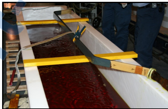
Figure 5.14 Le montage utilisé lors de l'essai de rupture diélectrique
