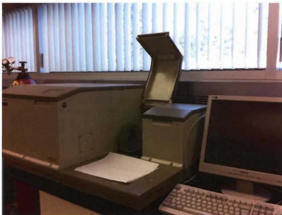
**Figure 3.6 :** Spectrophotomètre utilisé pour les IR
