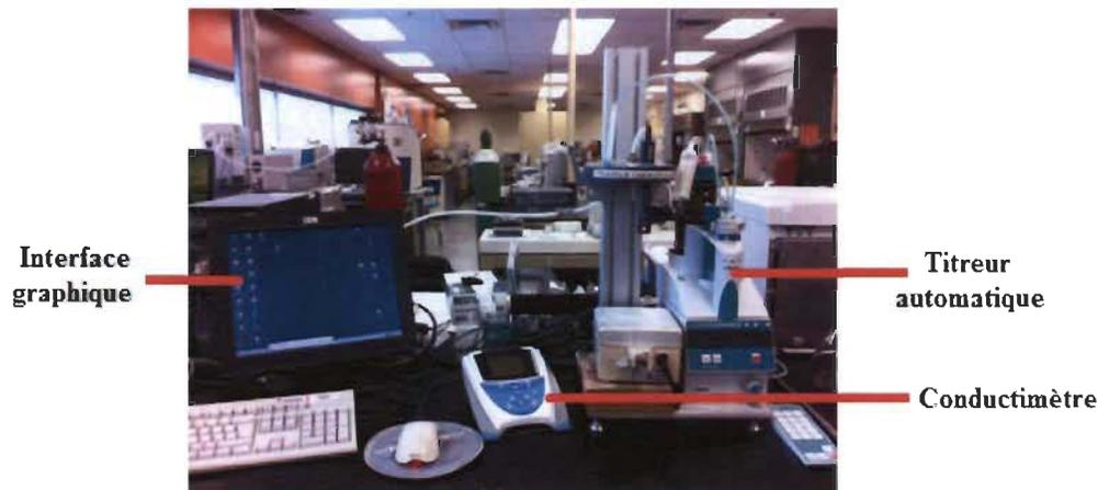
Figure 3.1 : Montage pour le dosage des carboxylates
