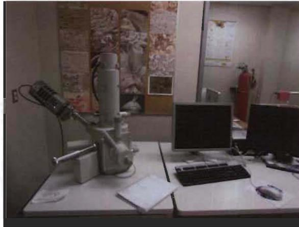
**Figure 3.8 : Microscope électronique à balayage**
