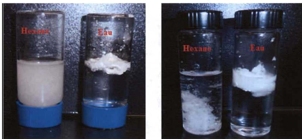
**Figure 4.34 :** Dispersion dans l'eau et dans l'hexane (à gauche le produit amidé et à droite le produit estérifié)
