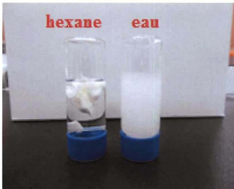
**Figure 4.33 :** TOCgel pur dans l'hexane (à gauche) et dans l'eau (à droite)
