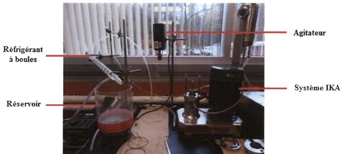
**Figure 3.3 : Montage de défibrillation de la cellulose oxydée**
