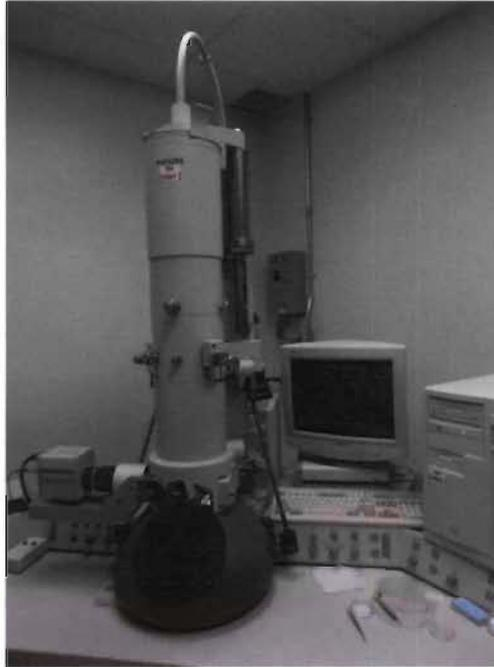
**Figure 3.9 :** Microscope électronique à transmission
