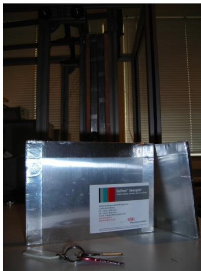
Figure 2.3 Plaques Energain (R) et aperçu du dispositif
