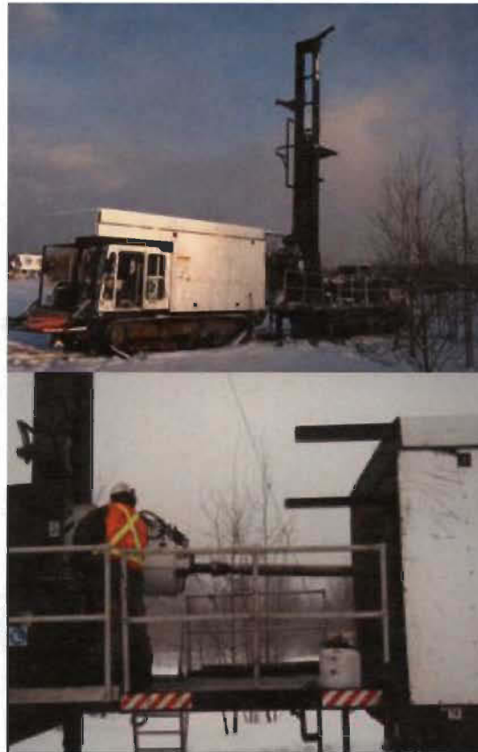
Figure 3.7 Système de forage Rotosonic.
