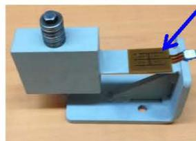
Figure 3. 12 : Photographie du transducteur piézoélectrique fabriqué
