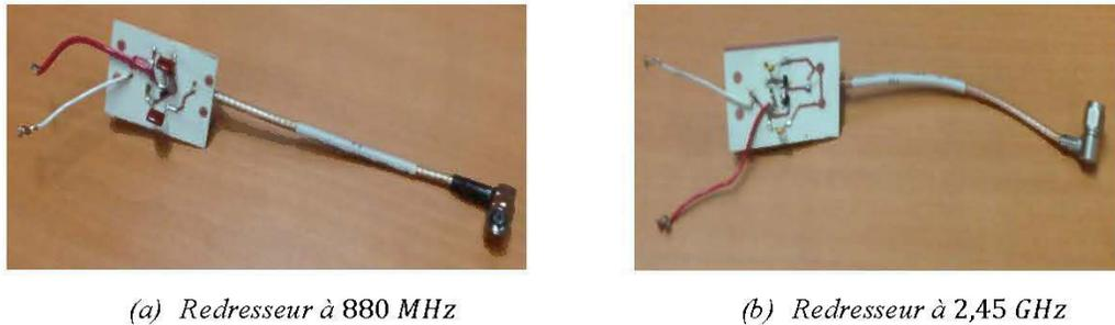
Figure 4. 15 : Photographies des circuits redresseurs
