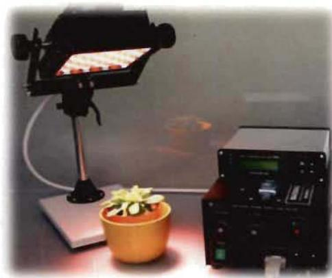
**Figure 2.1** Light control (LC100) avec les diodes DEL : dispositif de commande et d'émission de la lumière.
