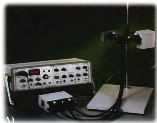
**Figure 2.2** XE-PAM (Pulse Amplitude Modulation): appareil de mesure de fluorescence.
