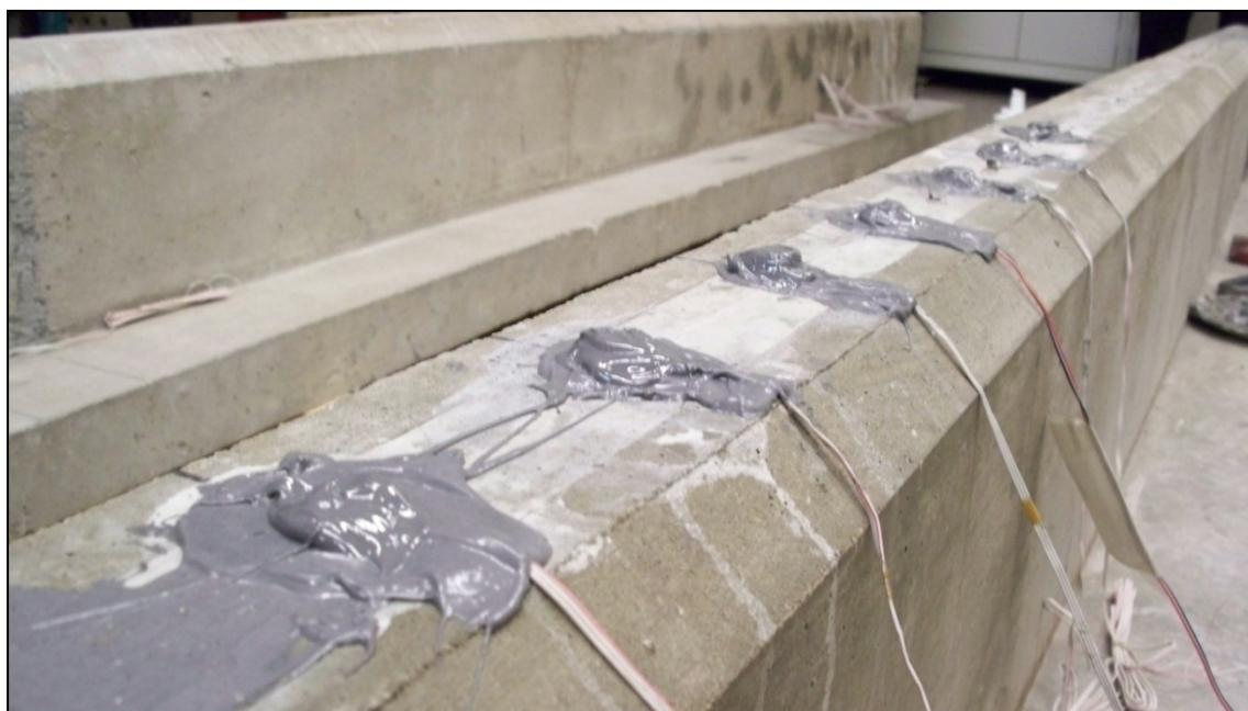
Figure-A II-13 Aspect extérieur final de la méthode ÉTS (extrémité des barres non poncées).
