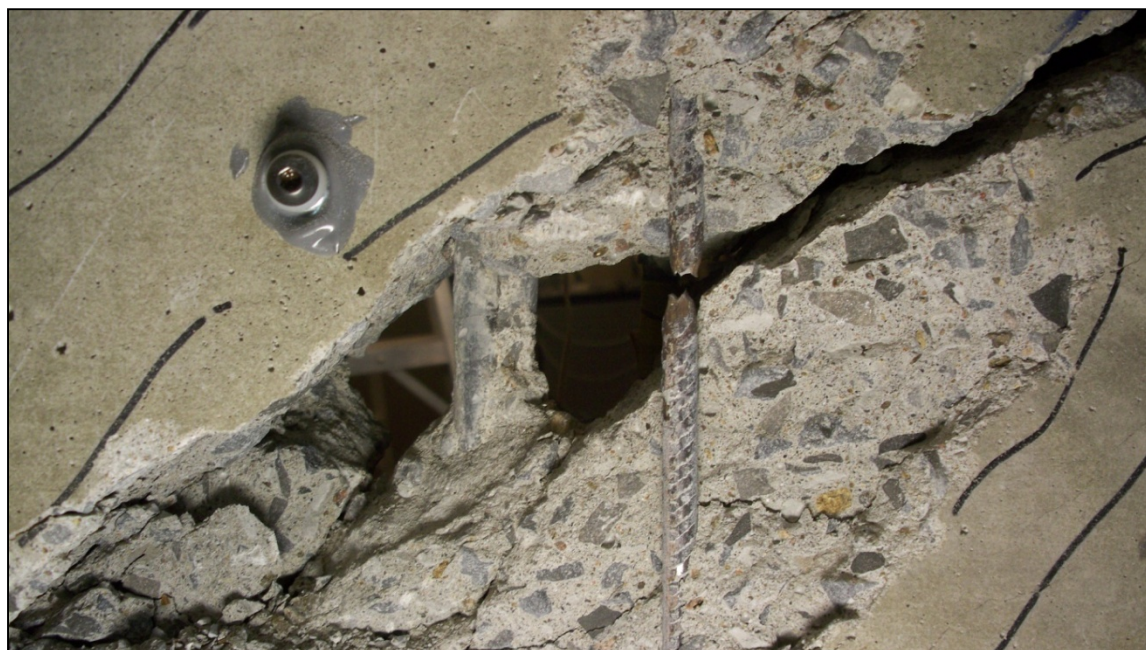
Figure 11.5 Rupture après plastification d'un étrier dans le spécimen S3-FE.
