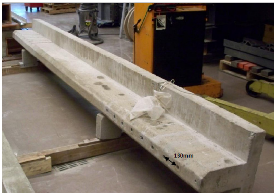
Figure 10.7 Espacement entre les trous pour la méthode ÉTS.
