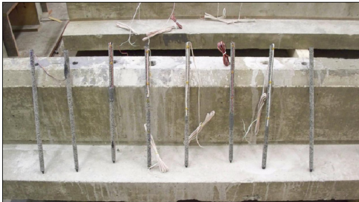
Figure 10.8 Disposition des barres instrumentées avant renforcement par la méthode ÉTS.
