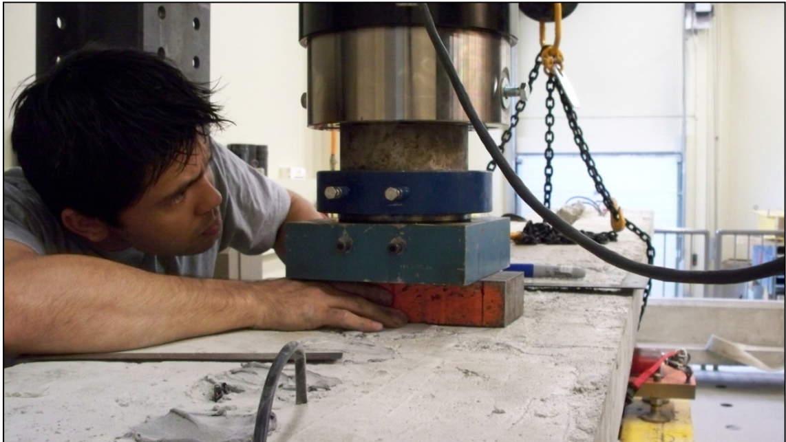
Figure-A II-19 Pose du système de transfert des charges entre le vérin et la poutre renforcée.
