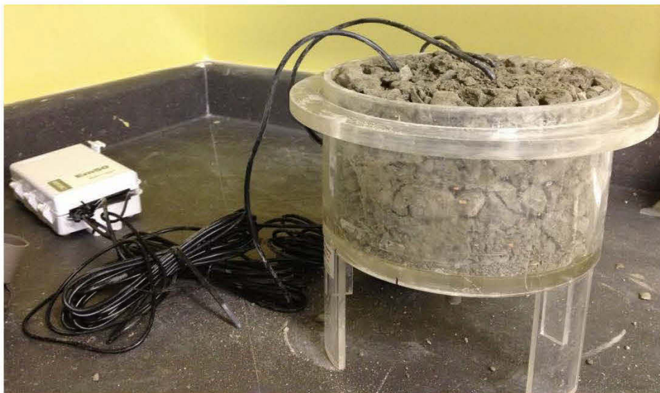
Moule et configuration de l'instrumentation utilisée pour le calibrage des sondes 5TM.
