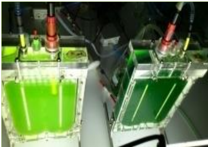
Figure 13 : Photobioréacteur plan (Bitog et al. , 2011)
