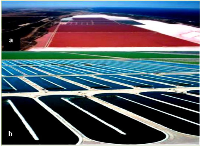
Figure 12 : Bassins : a) Culture de Dunaliella salina en bassins naturels de 200 ha, Cognis nutrition (Australie) b) Culture de Spiruline en raceway, Californie (Andersen, 2005)
